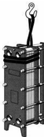
Строповка теплообменника без транспортных отверстий
