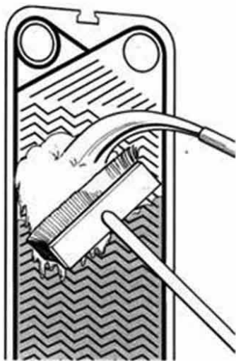
Рисунок В.2 – Схема очистки теплообменника моющей жидкостью и щеткой
